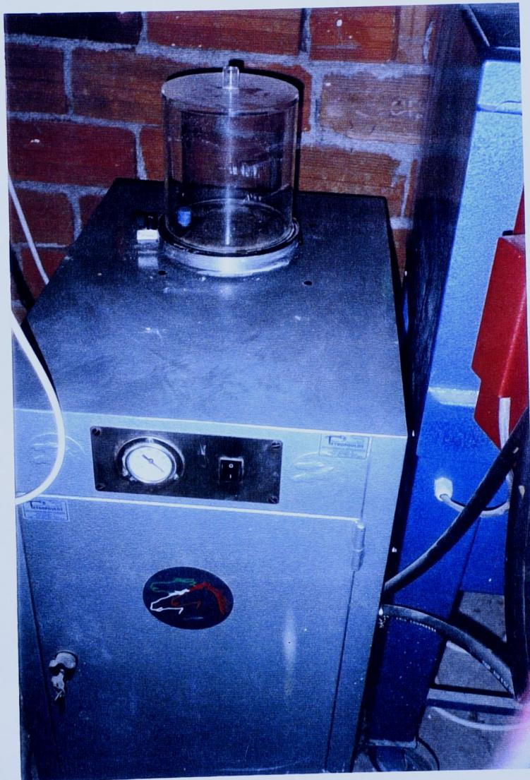
Εικ.61 Μηχάνημα αφαίρεσης αέρα από τα καλούπια που χρησιμοποιεί ο χρυσοχόος, για την κατασκευή κοσμημάτων.
