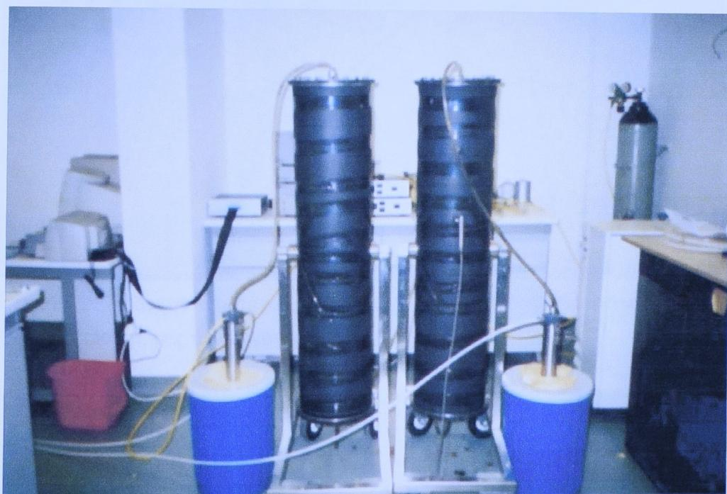
Εικόνα 5.1. Το σύστημα των κλειστών αντιδραστήρων που χρησιμοποιήσαμε.
